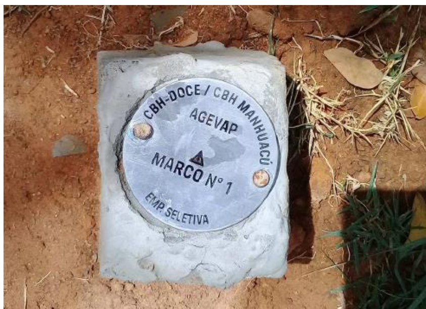
Figura 8 – Exemplo de marco topográfico
