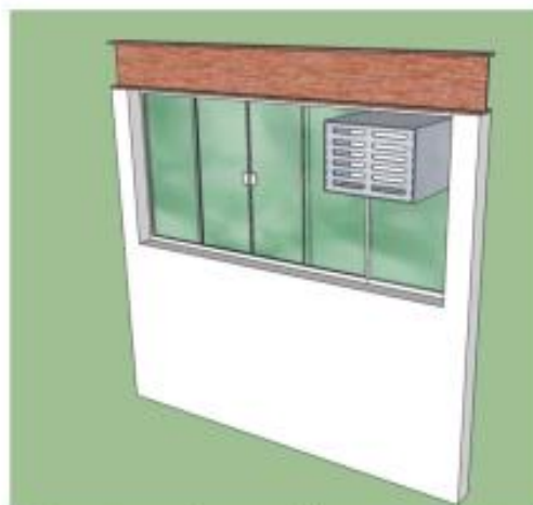
Vista externa da esquadria com o suporte em chapa de aço galvanizado e gradeamento metálico.
